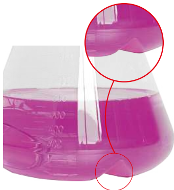
底部挡板设计增加气体交换效率
